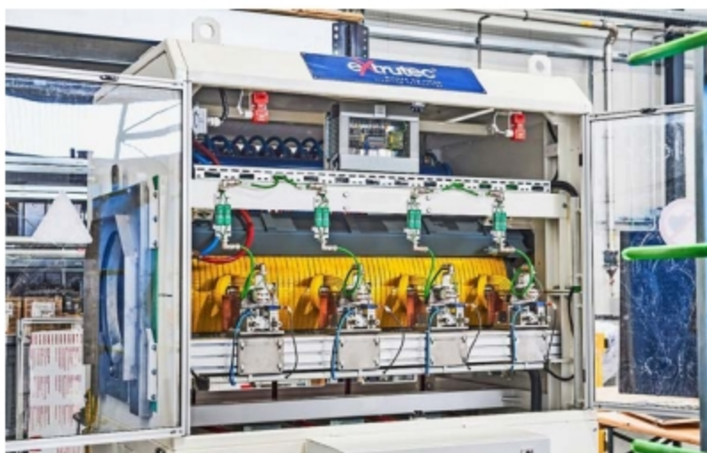
Das Prinzip des EHKO ähnelt dem eines Föhns: Die Luft im Ofen wird durch spezielle Heizelemente auf bis zu 750 °C erwärmt und auf die Aluminiumbolzen oder -stangen geblasen. Die finale Taper-Erwärmung erfolgt anschließend mittels Induktionsofen (im Bild).
