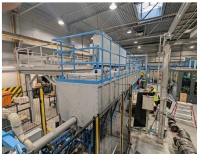
Die Module erwärmen die Aluminiumstrangen emissionslos und bedarfsgerecht.
