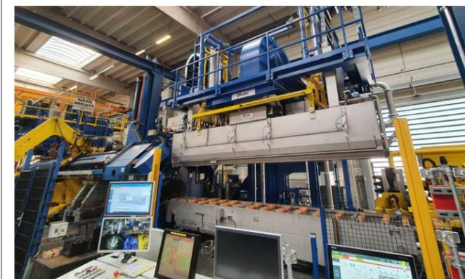
Parallel zum Profilverlauf angeordnete und motorisch schwenkbare Wasserquench-Düsenstöcke, mehrzonige Aufteilung mit Proportional-Druckregelung und Visualisierung der Profilgeometrie (Echtzeiten) gehören dazu. Ständige Materialoptimierung bei den Profilen führt zu immer höheren Anforderungen an die Anlagentechnik.
