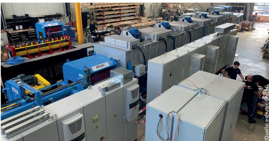
Bild 4: Vorinbetriebnahme des patentierten Inline-EHKO für den Erstkunden Mäkelä
