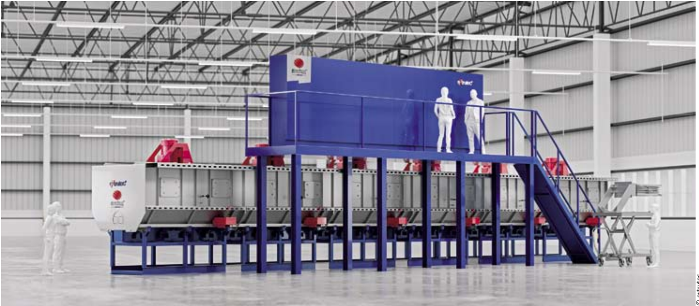
Der von extrutec entwickelte elektrisch widerstandsbeheizte Hochkonvektionsofen (EHKO) für die Erwärmung von Aluminiumstangen erreicht Wirkungsgrade von 87 Prozent / The high convection furnace equipped with electric resistance heating elements (EHKO) for heating aluminium logs, developed by extrutec, achieves an efficiency of 87%
