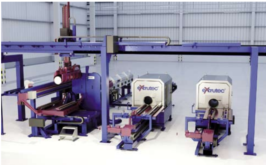
extrutec-Induktionsöfen der neuesten Generation, hier als Stand-alone-Ofen extrutec induction furnaces of latest generation, shown here as stand-alone version
