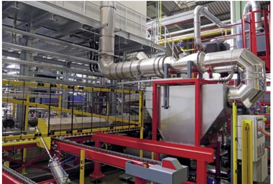
Die Eco Shower Unit (ESU) bietet deutliche energetische und wirtschaftliche Vorteile gegenüber einer konventionellen Stangenvorwärmung / The Eco Shower Unit (ESU) has clear energy and economic advantages compared with a conventional pre-heating system for aluminium logs
