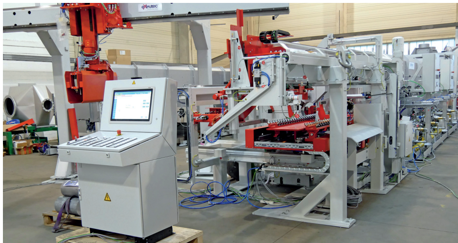
Inline-Ofenanlage mit Warmsäge und Bolzenmanipulator In-line furnace with a hot saw and billet manipulator
