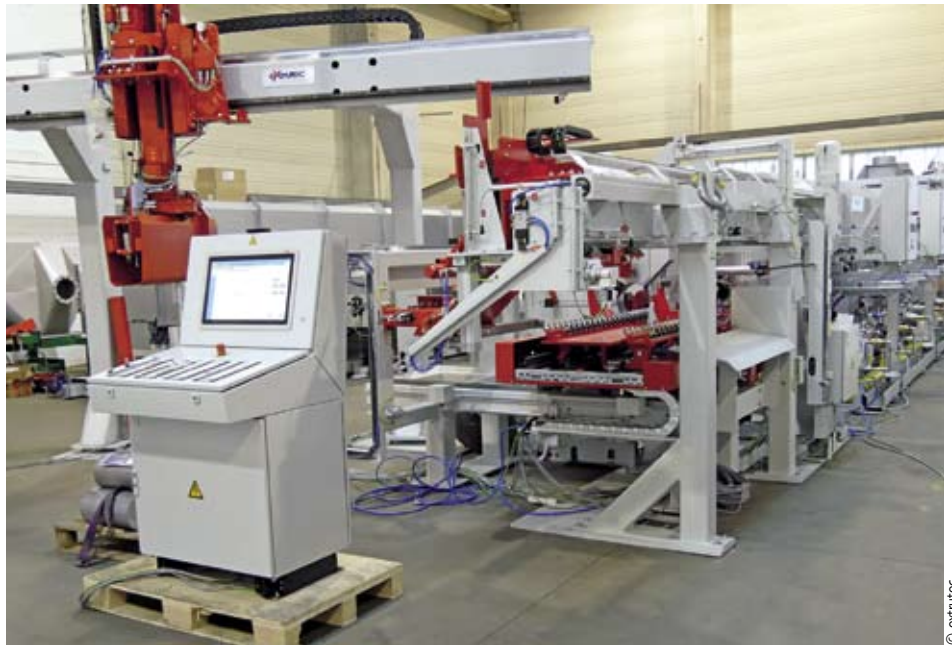
In-line-Ofenanlage mit Warmsäge und Bolzenmanipulator In-line furnace with a hot saw and billet manipulator
