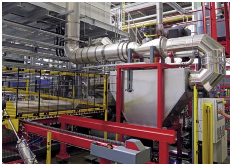
Die Eco Shower Unit bietet deutliche energetische und wirtschaftliche Vorteile gegenüber einer konventionellen Stangenvorwärmung / The Eco Shower Unit has clear energy and economic advantages compared with a conventional bar pre-heating system
