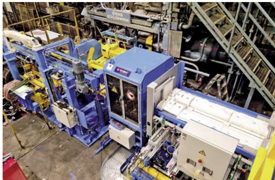
Der extrutec-Induktionsofen neuester Generation für isothermes Strangpressen The extrutec induction furnace – the latest generation for isothermal extrusion
