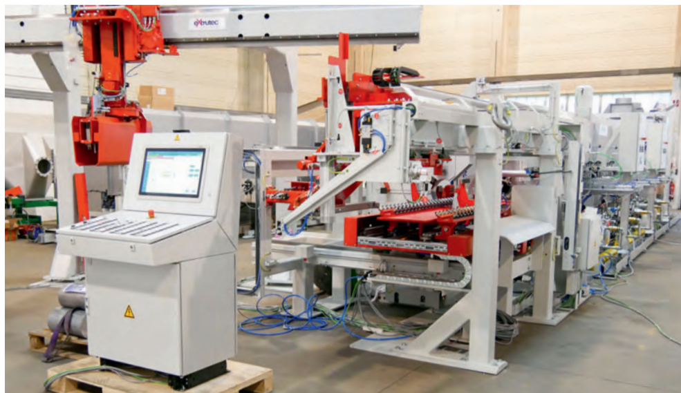
Neue 8“ extrutec Inline-Ofenanlage (patentiert) mit Warmsäge für Stangen und Bolzenmanipulator
