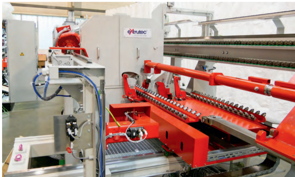
Detailansicht einer neuen 8“ Warmsäge für Stangen mit Bolzenquertransport
