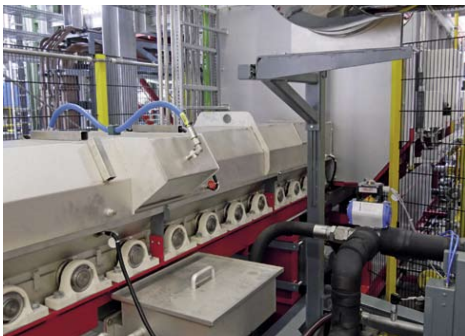
Die vorgewärmten Stangen durchlaufen danach eine in die ESU integrierte Stangenreinigungsanlage The preheated log then passes through a log cleaning system integrated into the ESU
