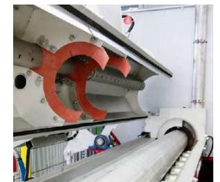
ein auf bis zu 90 °C erwärmtes Wasser. In einer dem Gasofen vorgeschalteten Einheit werden die Aluminiumstangen durch laminare Benetzung der gesamten Oberfläche mit Heißwasser auf Temperaturen von bis zu 90 °C vorgewärmt. Eine weitere Pionierleistung zum Nutzen unserer Kunden und zum nachhaltigen Schutz unserer Umwelt.
