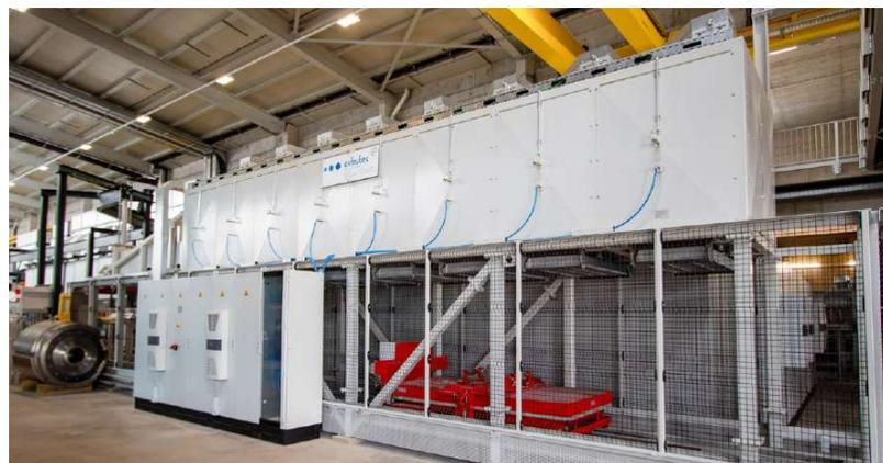
Unsere neueste Entwicklung: Ein Flurofen, der seitlich mittels eines Shuttles beschickt wird. Dieser extrem platzsparende Ofen kann in Hallen installiert werden, in denen alle anderen Konzepte auf Grund mangelnder Höhe scheitern oder unnötig hohe Investitionen nach sich ziehen würden.
