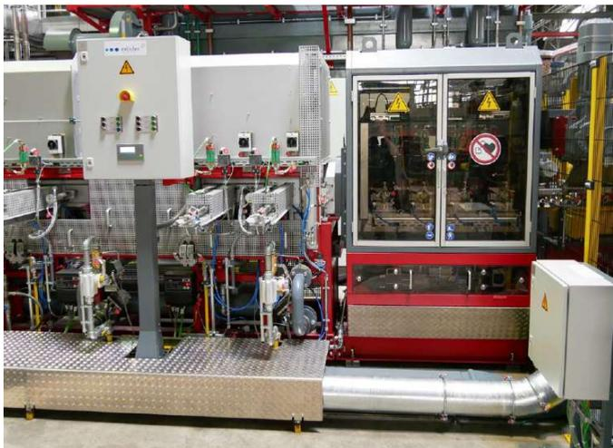
Merkmale, die viele unserer Premiumkunden zu einer Kaufentscheidung in den vergangenen Jahren bewegt haben. Die kostengünstige Grunderwärmung mittels Gas sowie das anschließende Aufbringen eines präzisen Tapers mittels Induktion sind das derzeit beste Erwärmungskonzept. Diese Merkmale sind besonders wichtig bei hohen Anforderungen an das Endprodukt, wie dies z.B. im Automobilbau der Fall ist.
