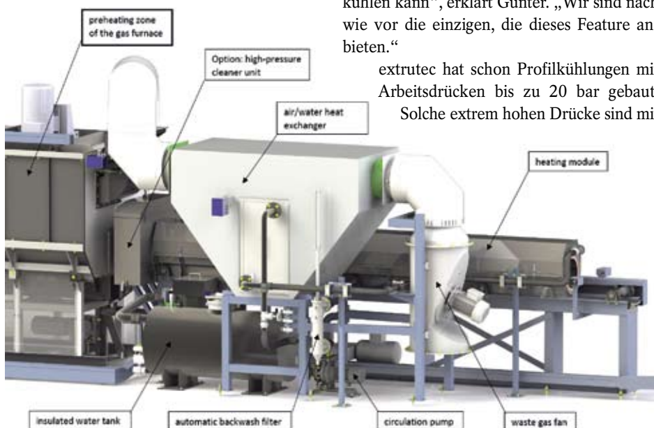
Die Eco Shower Unit bietet deutliche energetische und wirtschaftliche Vorteile gegenüber einer konventionellen Stangenvorwärmung / The Eco Shower Unit offers substantial energy and economic advantages compared with conventional log preheating
