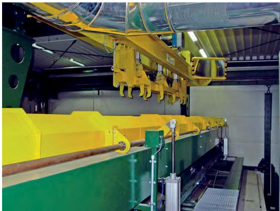
Mit einem zusätzlichen Vorwärmmagazin für acht Stangen, wie sie bei Schletter/HAI eingesetzt wird, lässt sich der Energiebedarf zur Bolzenerwärmung zusätzlich erniedrigen
