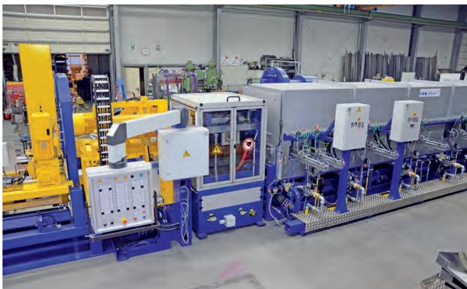
Vor der Presse hat sich zur Bolzenerwärmung die Kombination aus Gas- und Induktionsofen als vorteilhaft erwiesen. Der Energieverbrauch im Gasofen konnte durch eine Reihe Maßnahmen reduziert werden.
