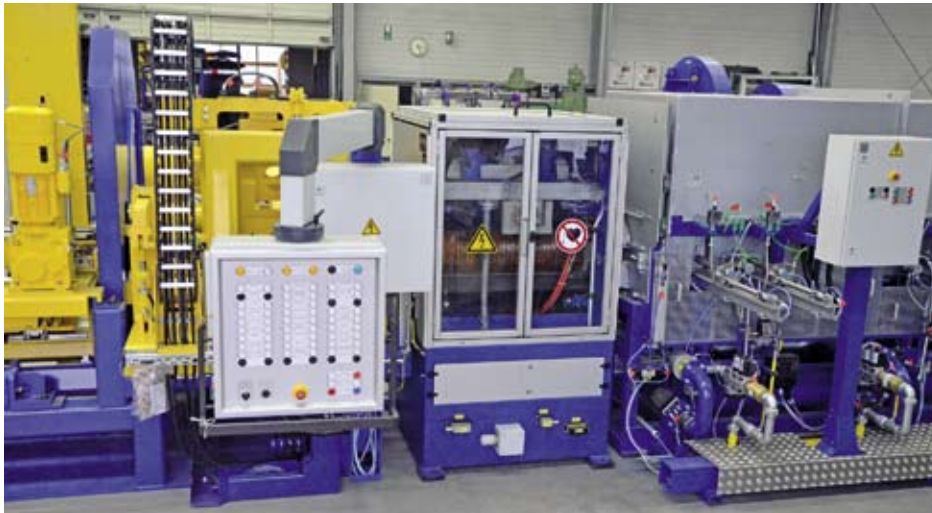
Das Konzept, Gas- und Induktionsofen direkt hintereinander in einer Linie zu installieren, bietet eine Reihe von Vorteilen gegenüber der Stand-alone-Lösung / The concept to install the gas and induction furnaces one after the other in one line offers many advantages compared with the stand-alone arrangement
