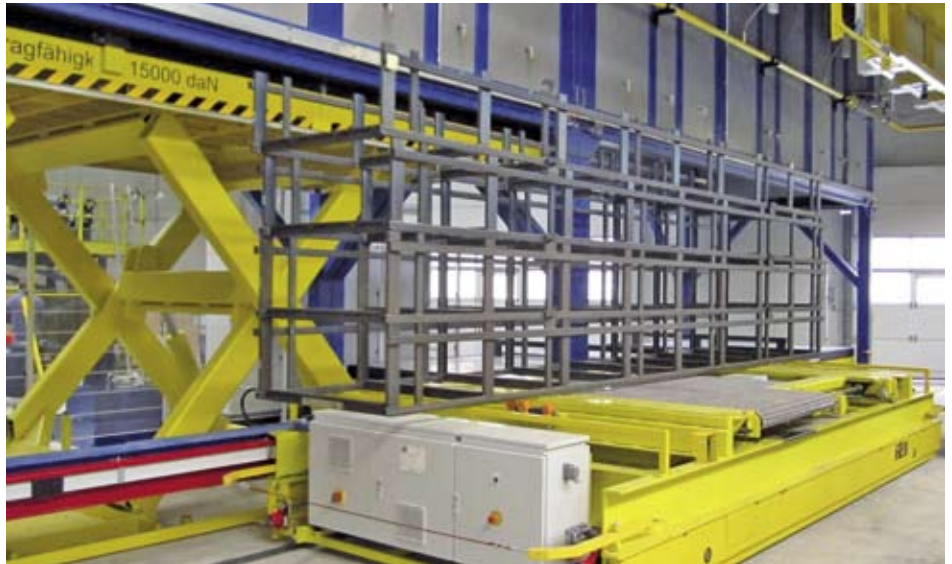
Warmauslagerungsöfen als Überkopfausführung mit Shuttle für automatisierten Materialfluss Ageing oven in overhead arrangement with a shuttle for automated material flow
