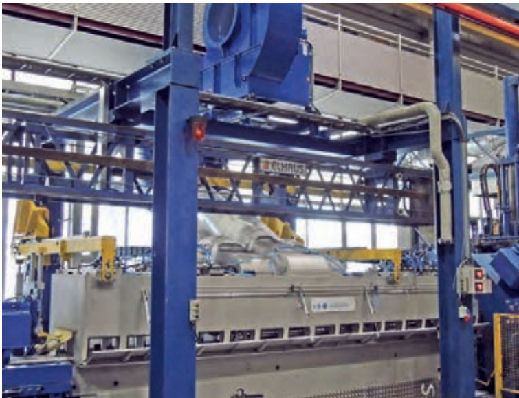
Bei der Profilkühlung konzentriert sich extrutec auf die Intensivkühlung von hochwertigen, speziellen Profilen, wie sie vor allem im Automobil- und Flugzeugbau verwendet werden
