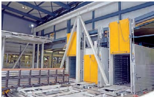
Warmauslagerungsöfen (Flurversion) mit automatischer Beschickung Ageing furnace (floor-mounted version) with automatic loading system
