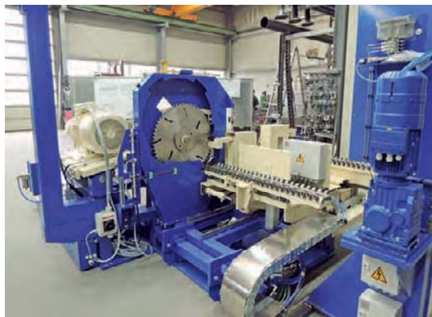
Das Warmmägen bietet klare Vorteile gegenüber dem Warmescheren Hot sawing has clear advantages compared with hot shearing
