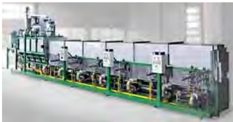
Moderner Gasanwärmofen mit sechs individuell regelbaren Heizzonen und Vorwärmszone
