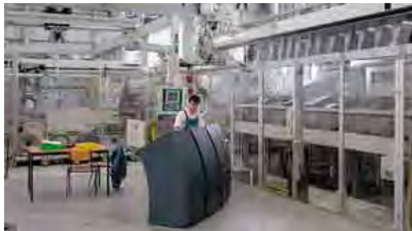
Bolzenerwärmung bei Alu Menziken: Links im Bild ist einer der drei parallelen Induktionsöfen erkennbar, darüber der Greifer zum Bolzentransport
