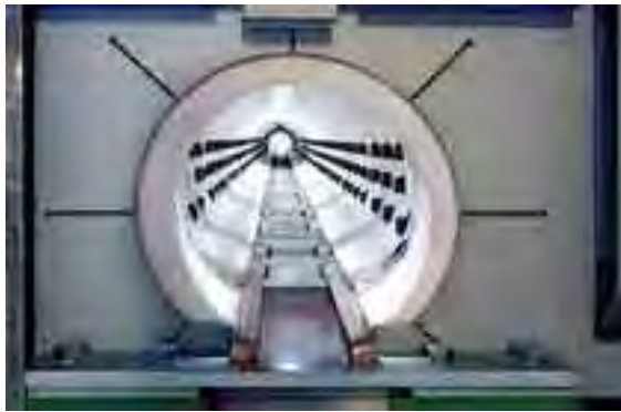
Frontale Ansicht des Gasanwärmofens mit 2 x 3 Düsenreihen. Von unten ragen die Antriebsrollen in die Heizkammer hinein
