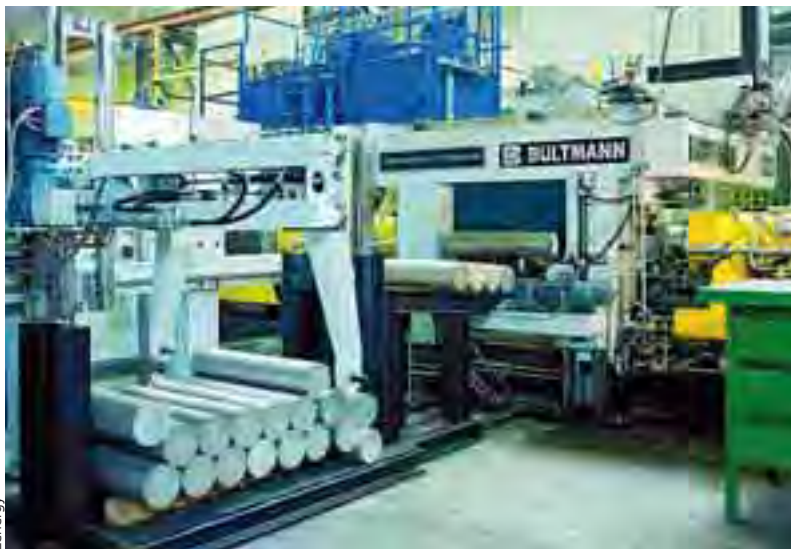
Seit etwas mehr als einem halben Jahr ist bei der Mindener Weseralu GmbH erstmalig ein neuartiger HTS-Induktionsheizer in Betrieb, der den physikalischen Effekt der Supraleitung nutzt und etwa 50 Prozent weniger Strom als herkömmliche Systeme verbraucht
