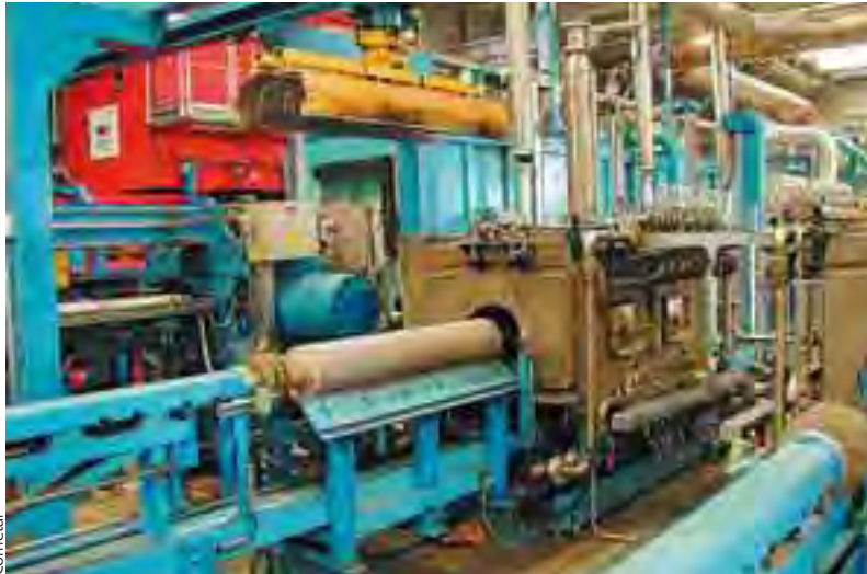
Taper-Quench Anlage – Der überhitzte Bolzen wird hier gezielt abgekühlt, so dass das gewünschte Temperaturprofil entsteht
